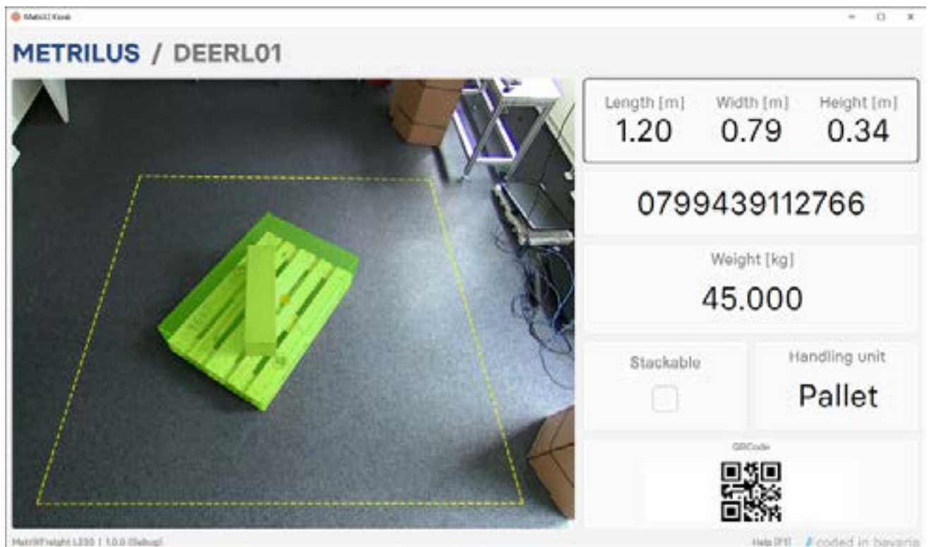
Figura 2: Interfaccia dell'applicazione con due aree: (sinistra) vista immagine live dell'oggetto misurato; (destra) area dei widget con i dati di misura e widget opzionali, "ID" e codice QR sullo schermo.
