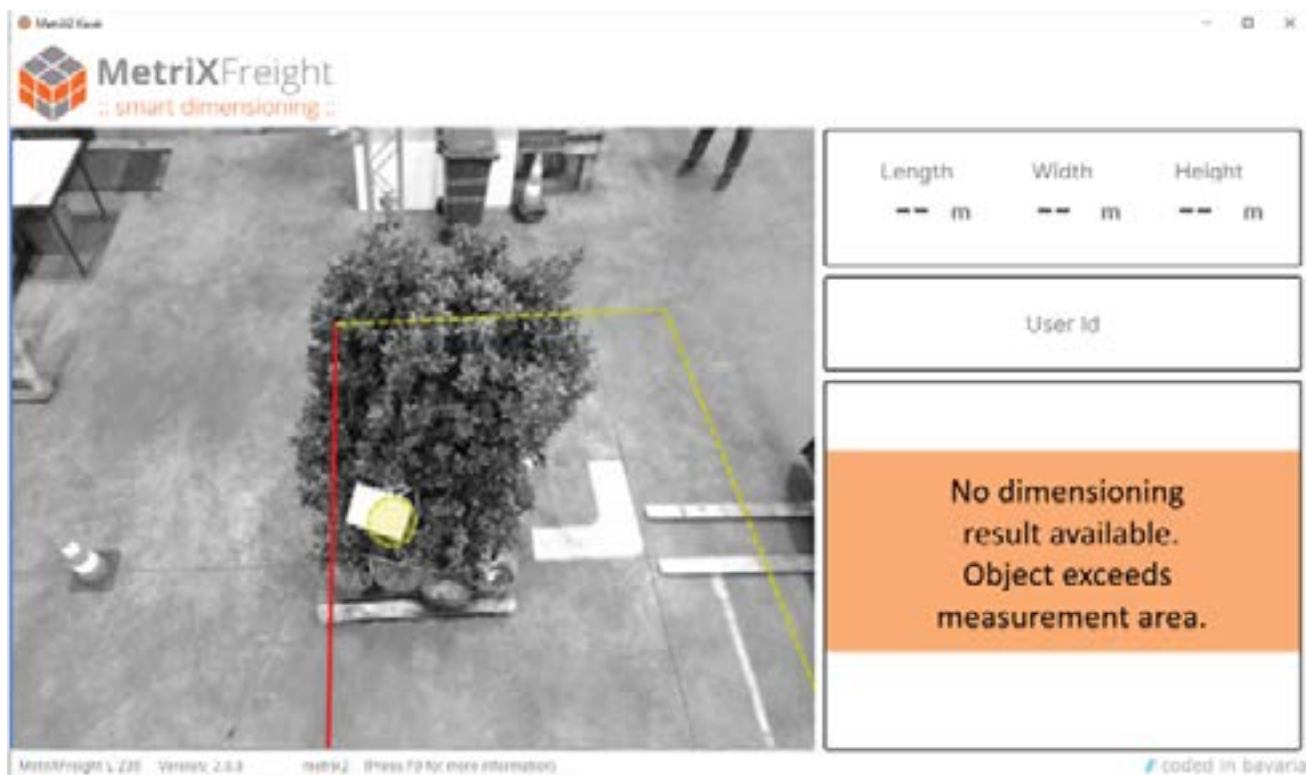
Figura 3: Un oggetto è posizionato in modo errato e supera l'area di misurazione su un lato. Viene mostrato un messaggio di errore e il lato interessato viene colorato in rosso.
