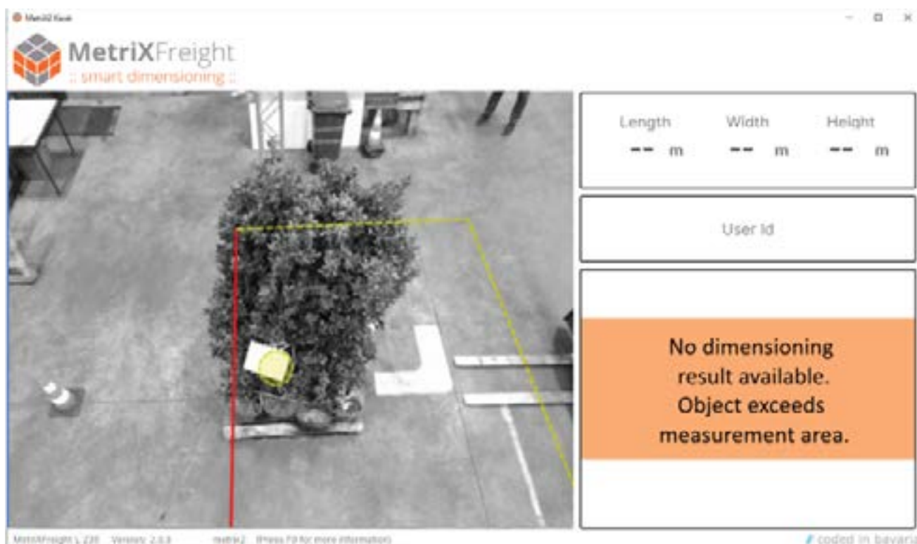
Figure 3 : Un objet est mal positionné et dépasse la zone de mesure d'un côté. Un message d'erreur apparaît et le côté concerné est affiché en rouge..
