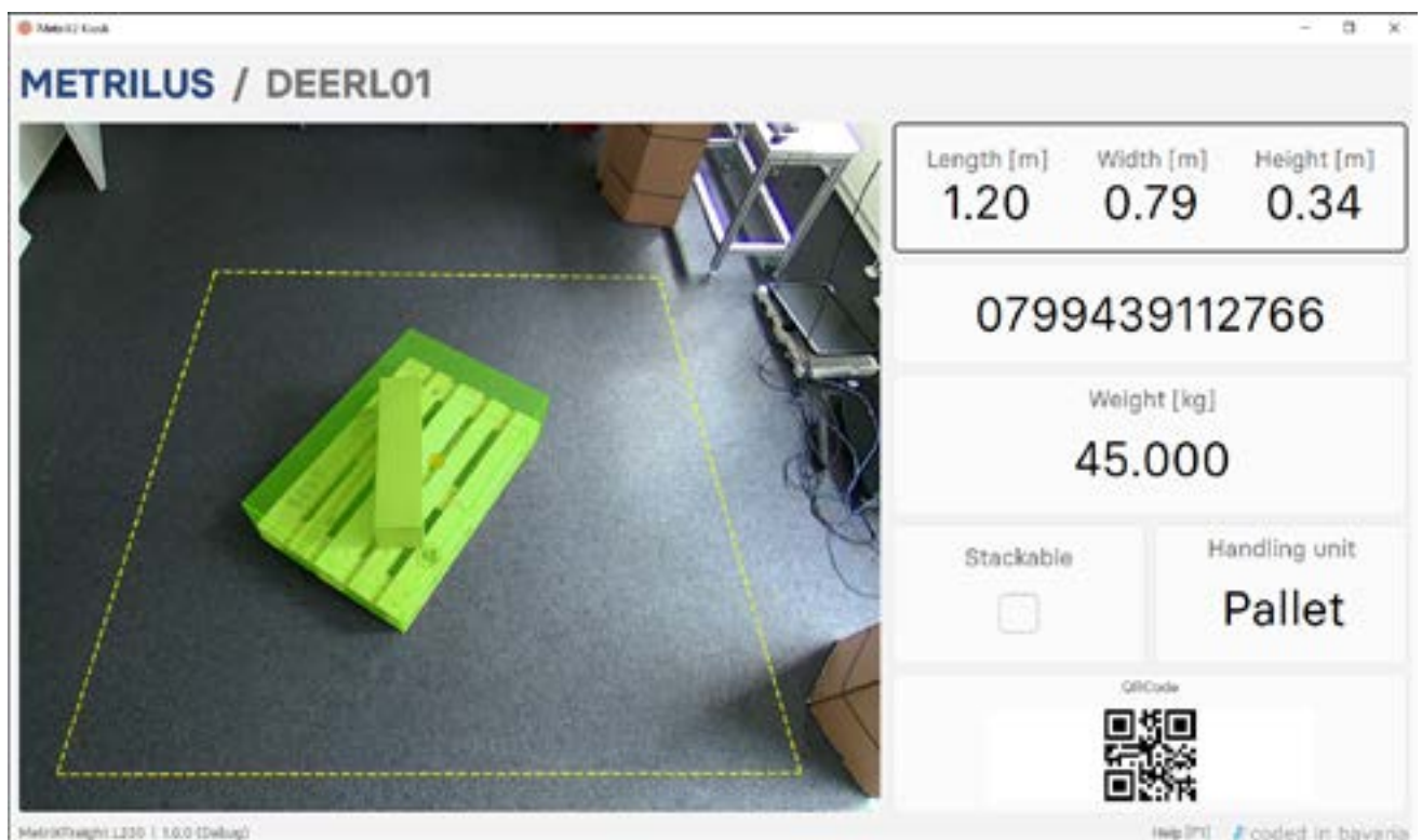
Figure 2 : Interface de l'application avec deux zones : (à gauche) vue d'image en direct de l'objet mesuré ; (à droite) zone des widgets avec les données de mesure et les widgets optionnels « ID » et code-QR à l'écran.
