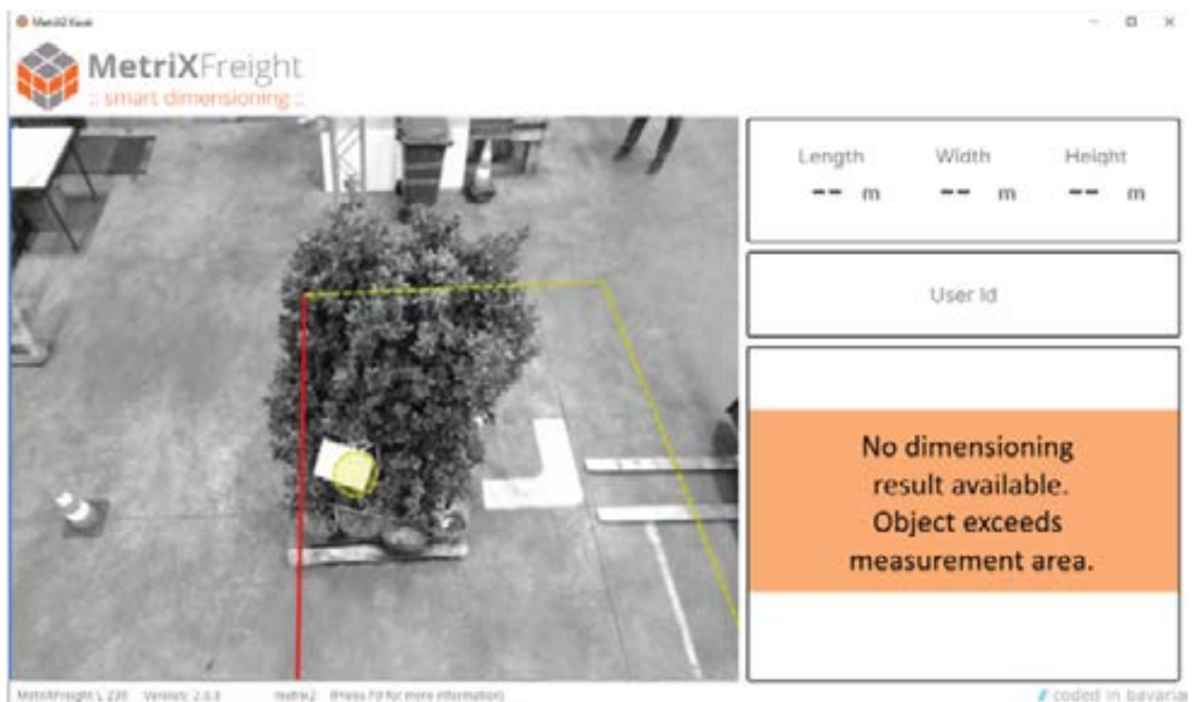
Abbildung 3: Ein Objekt ist falsch positioniert und ragt über den Messbereich hinaus. Eine Fehlermeldung erscheint und die betroffene Seite wird rot dargestellt.
