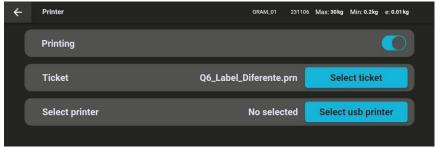
Der **Druck-Schalter** ermöglicht es, den automatischen Druck nach der Aufzeichnung eines neuen Wägevorgangs zu aktivieren oder zu deaktivieren.
