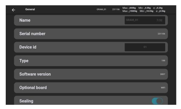
Der **Versiegelungsschalter** zeigt an, ob die Waage als geeicht ist. In diesem Fall können viele der Waageneinstellungen nicht geändert werden.
