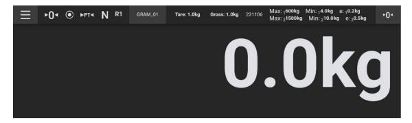
Nach dem auflegen eines Objekts auf die Waage zeigt der Hauptindikator das Nettogewicht an.
