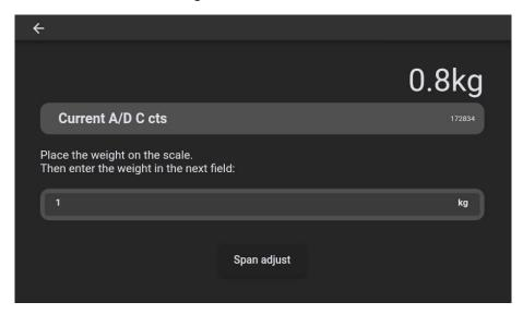
Die Z8i berechnet den Divisor, der benötigt wird, um das Signal der Wägezelle in die zuvor definierte Wägeskala umzuwandeln.
