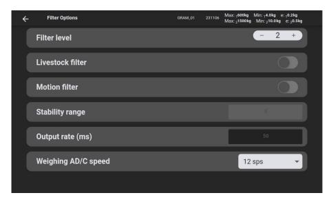
**Filterstufe** Mögliche Werte reichen von **1** bis **6**. Ein kleinerer Wert bedeutet, dass schnelle Gewichtsschwankungen sichtbarer werden, und umgekehrt. Der Standardwert ist Stufe **2**.
