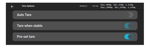
**Automatische Tara** Wenn diese Funktion eingeschaltet ist, führt die Waage bei jedem Beladen automatisch eine gemessene Tara durch. Dies ist nützlich beim Befüllen von Behältern, um die Tara-Taste nicht jedes Mal betätigen zu müssen.
