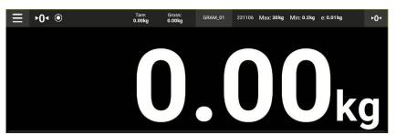
Um das Gewicht eines beliebigen Objekts innerhalb des maximalen Wägebereichs der Waage zu ermitteln, platzieren Sie es auf der Wägeplattform:
