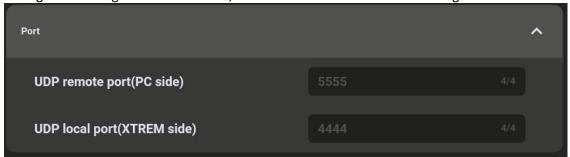
Der **Remote-Port** ist der Port, der die Nachrichten der Waage empfängt. Er ist standardmäßig auf **5555** eingestellt (Werkseinstellung).
