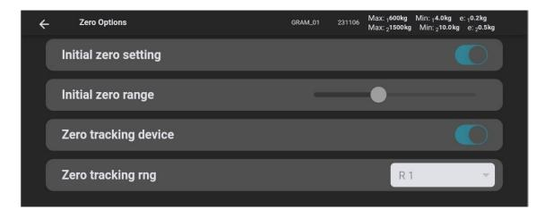
**Initiale Nullstellung** Aktiviert oder deaktiviert die automatische Nullstellung beim Einschalten der Waage über den Schalter:
