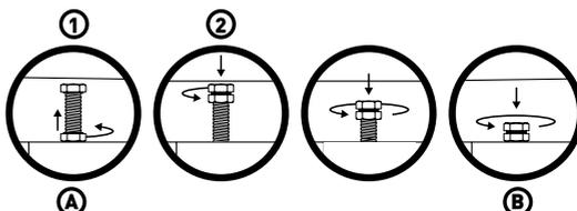
1. Desserrer les écrous inférieurs des 4 boulons de blocage.
